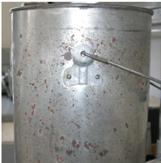
Koroze železa na cínované nádobě a kování
