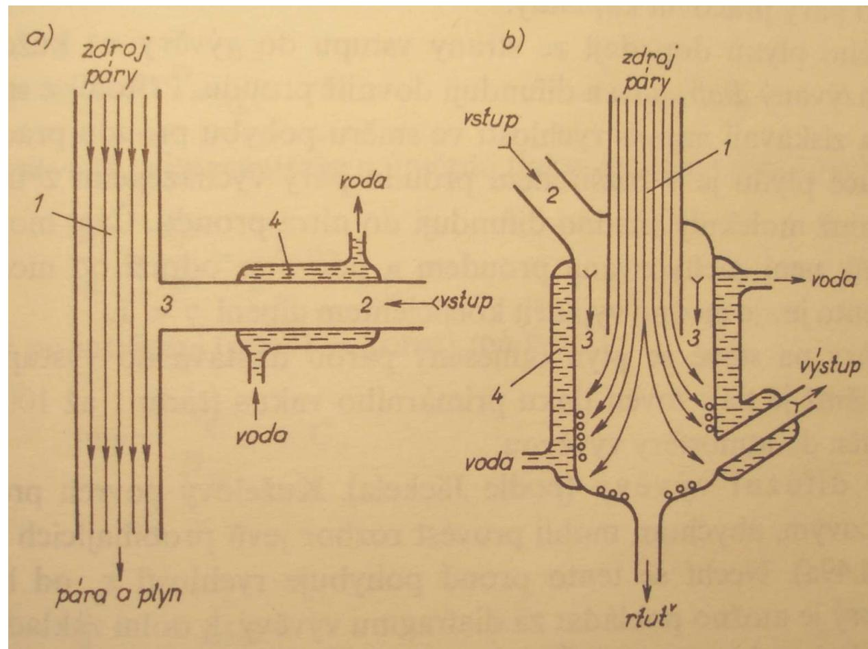
Obr. 4.47. Difúzní vývěvy: a) Gaedeho, b) Langmuirova
