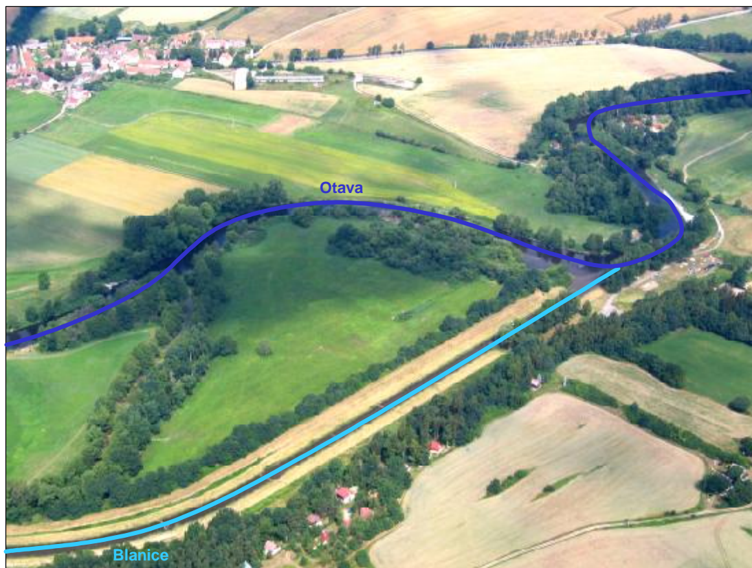
Obr. 5 Geometricky upravená trasa koryta Blanice u soutoku s Otavou (Foto: J. Langhammer, 2003)
