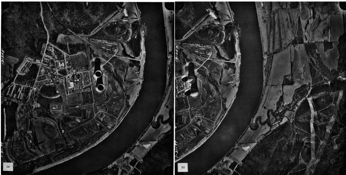
Obr. 6.4. Efekt radiálních posuvů na letecké fotografii předmětů s výrazným vertikálním rozměrem
