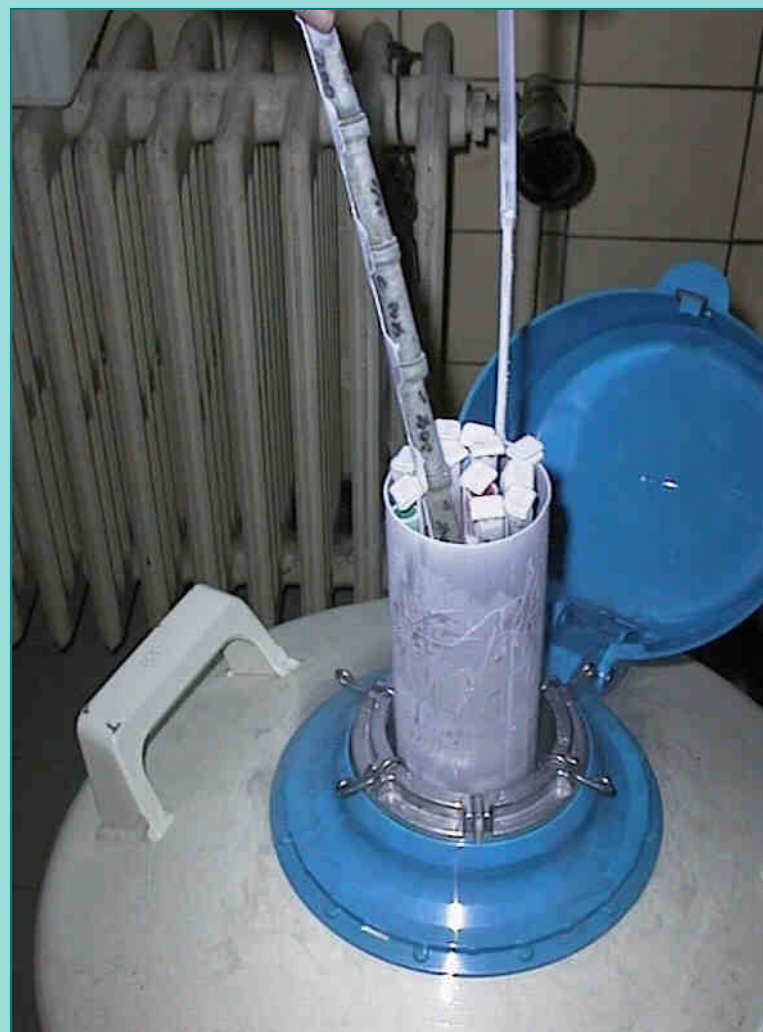
Ukládání vzorků do tekutého N 2
