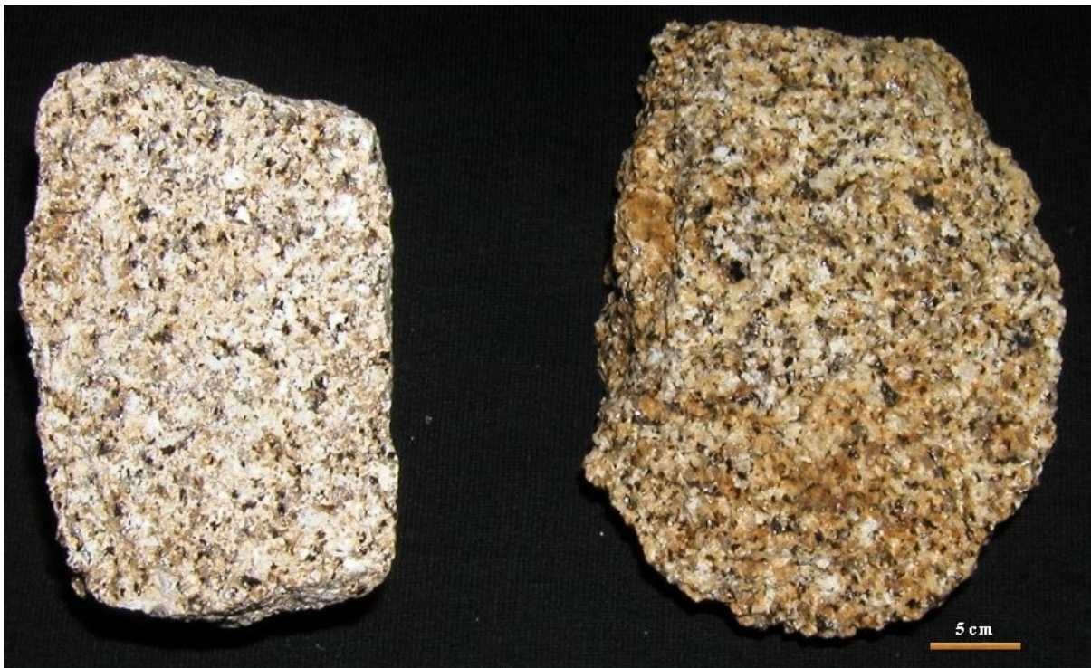
Obr. 4 Dvě barevné variety makrovzorků mrákotínského granitu. V pravé části snímku zvětrávání. Foto M. Hudec.
