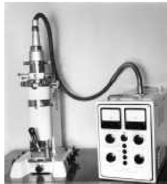
Stolní elektronový mikroskop Tesla BS242 (1954)
