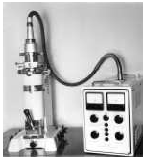
Stolní elektronový mikroskop Tesla BS242 (1954)
