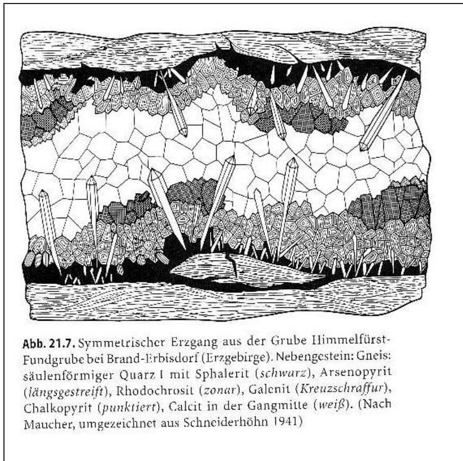
**Abb. 21.7.** Symmetrischer Erzgang aus der Grube Himmelfürst-Fundgrube bei Brand-Erbisdorf (Erzgebirge). Nebengestein: Gneis; säulenförmiger Quarz I mit Sphalerit (*schwarz*), Arsenopyrit (*längsgestreift*), Rhodochrosit (*zonal*), Galenit (*Kreuzschraffur*), Chalkopyrit (*punktiert*), Calcit in der Gangmitte (*weiß*). (Nach Maucher, umgezeichnet aus Schneiderhöhn 1941)
