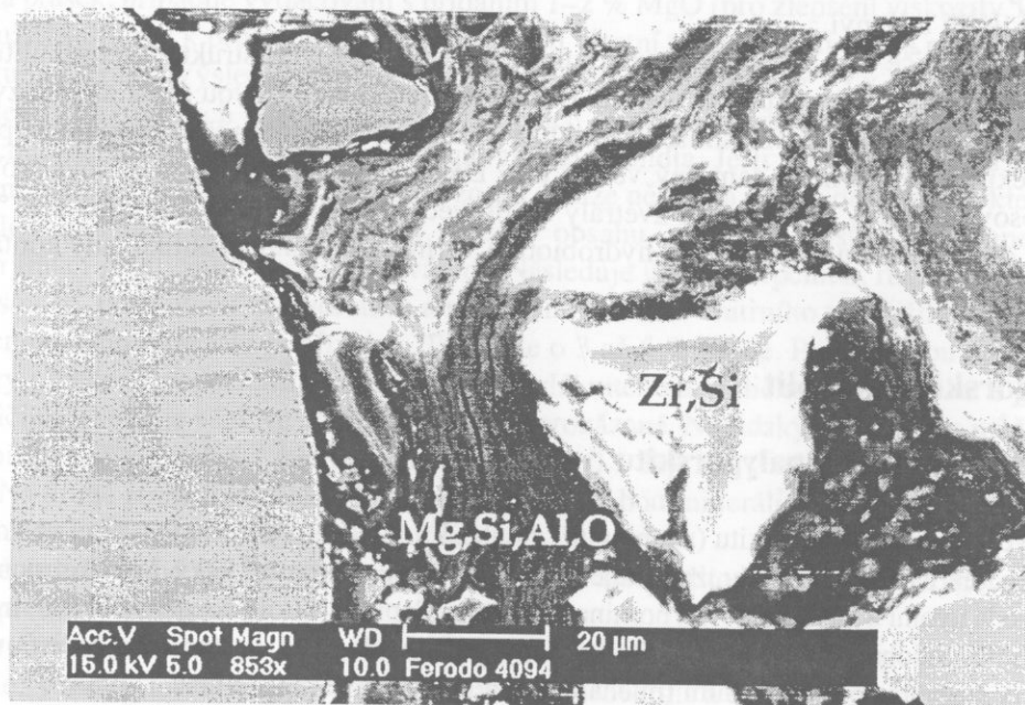
Obr. 10.2. SEM fotografie nábrusu automobilového brzdového obložení s částicemi Mg-vermikulitu, zirkonu a kovů. Zprohýbaná částice Mg-vermikulitu, obklopující úlomek zirkonu (ozn. Zr, Si), je označena prvky Mg, Si, Al, O, které byly zjištěny bodovou chemickou analýzou na elektronovém mikroskopu.
