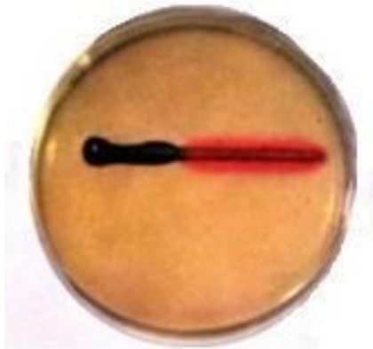
Obrázek 1 – Lokalizace anody (vlevo) a katody (vpravo) v galvanickém článku železo - měď
