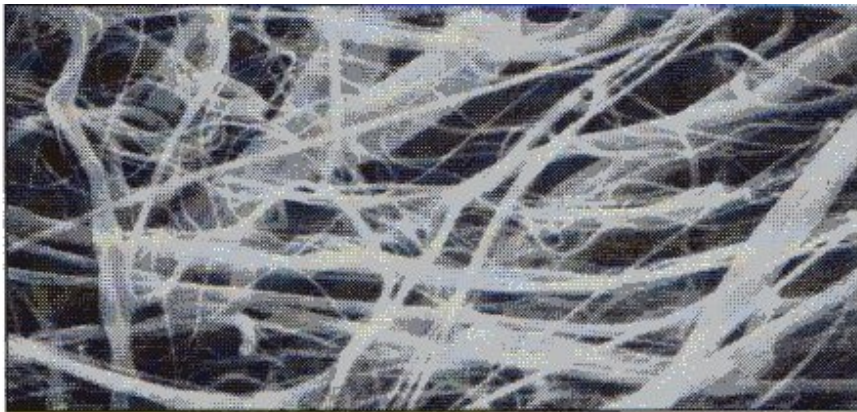
Melt Blown Fasern mit ca. 0,1 dtex (1:500)
