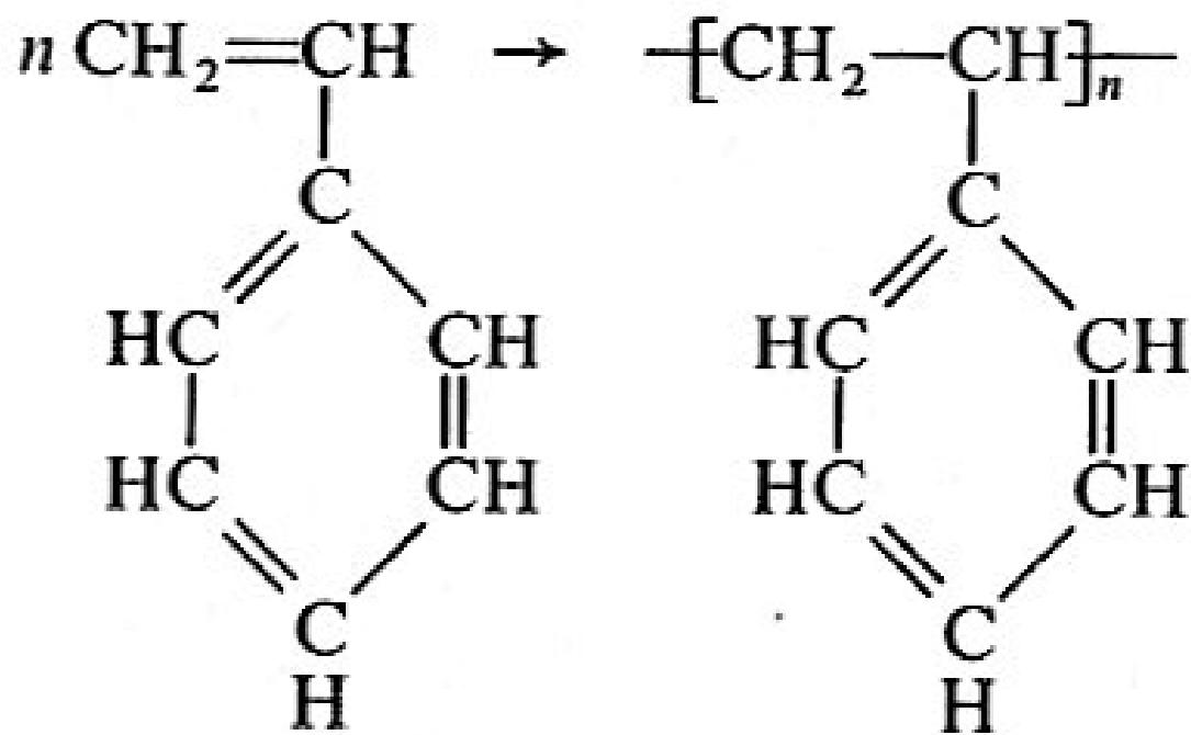
Do tříhrdlé baňky (obr. 8) vložte 80 ml destilované vody a za ho míchání vlijte roztok 3 g CaCl<sub>2</sub> v 30 ml destilované vody a roz- 6 g Na<sub>3</sub>PO<sub>4</sub> ve 30 ml destilované vody. Pak nadávkujte roztok 0,6 g mzojylperoxidu ve 25 ml vyčištěného styrenu. Zahřívejte na teplotu ž 98 °C při intenzívním míchání až do ztvrdnutí perliček (asi 50 minut).
