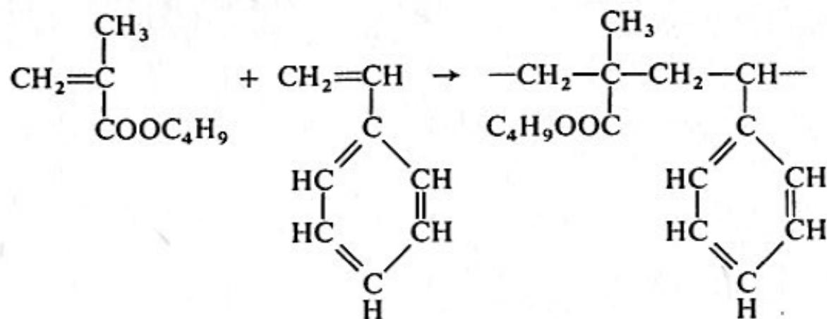
V tříhrdlé baňce (obr. 8) rozpustte 0,3 g dibenzoylperoxidu v směsi 12,5 ml vyčištěného styrenu a 12,5 ml předestilovaného butylmethakrylátu. Za stálého míchání přidejte 100 ml destilované vody a 3 g jemně rozetřeného kaolinu. Polymerační teplotu udržujte na 95 až 98 °C po dobu 100 až 120 minut. Za stálého míchání reakční směs ochladte a perličky izolujte dekantací. Vysušte je za laboratorní teploty, zjistěte velikost a výtěžek v procentech.
