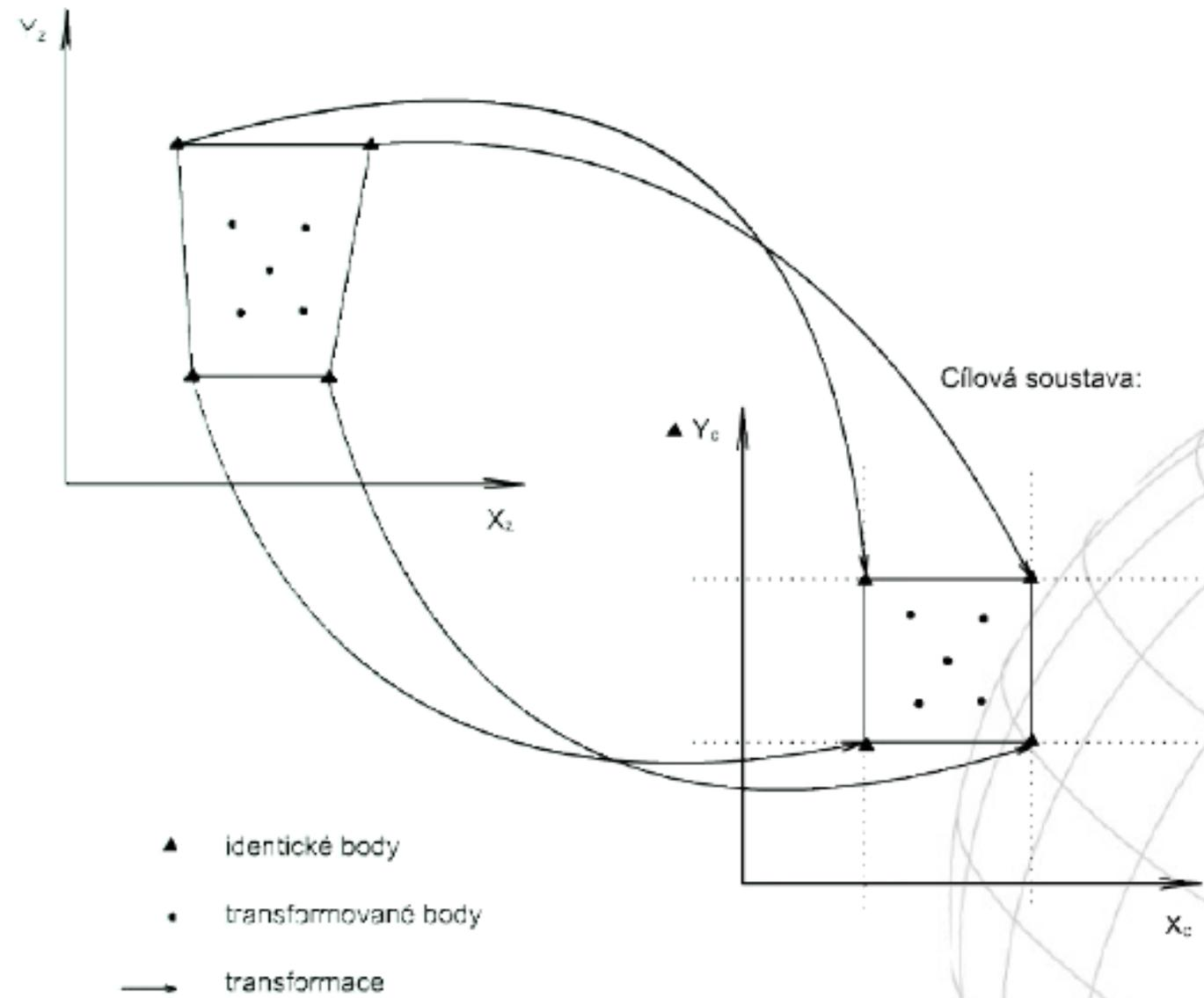
Transformace mezi rovinnými pravoúhlými souřadnicemi jsou založeny na poznání přesné polohy vybraných identických bodů.
