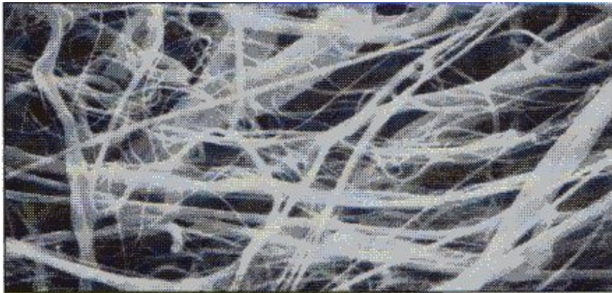
Melt Blown Fasern mit ca. 0,1 dtex (1:500)
