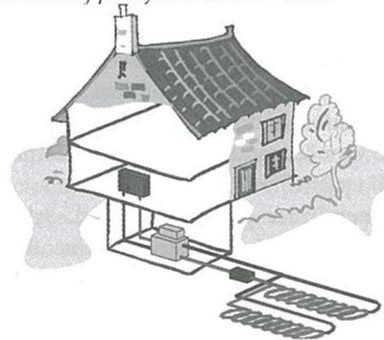
Obr. 8 Primární zdroj pro systém země – voda.
