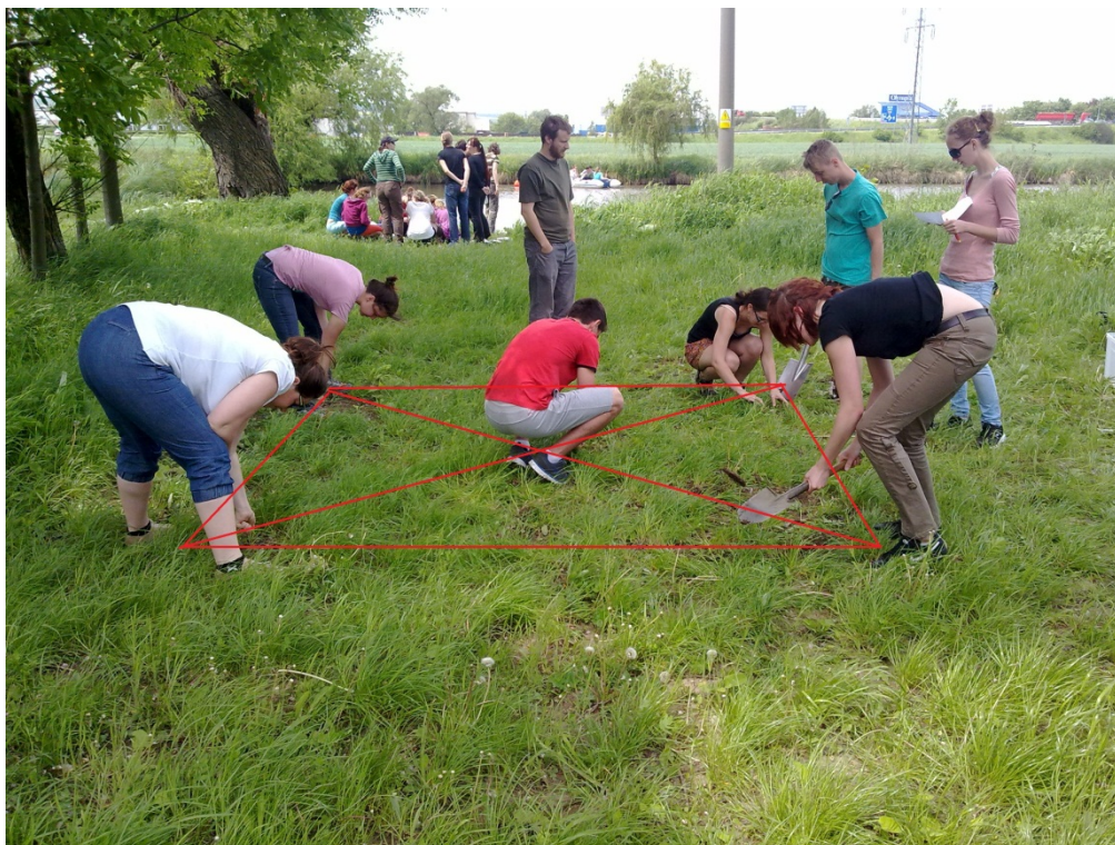
Obrázek 5: Vzorkovací síť pro odběr vzorků půdy
