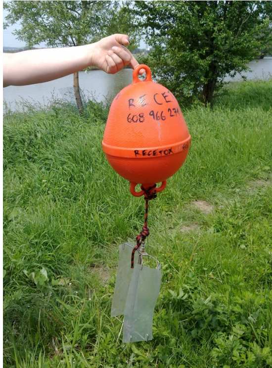
Obrázek 3: Pasivní vzorkovač vody se silikonovou gumou
