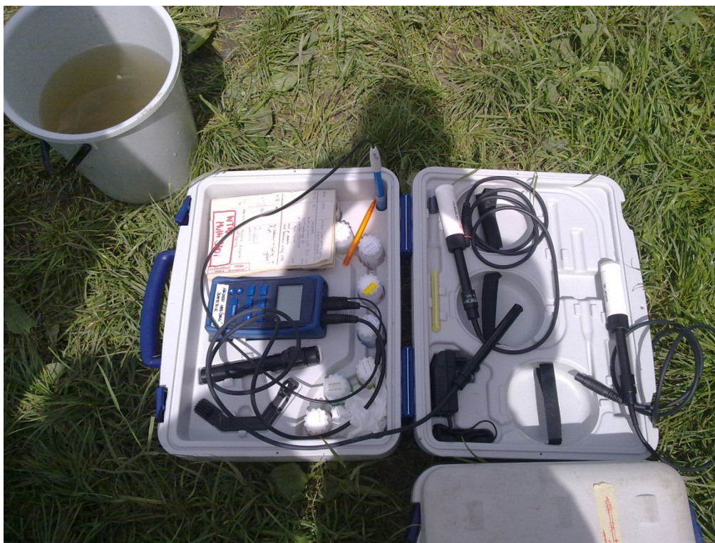
Obrázek 8: Souprava pro měření základních parametrů vzorků vod
