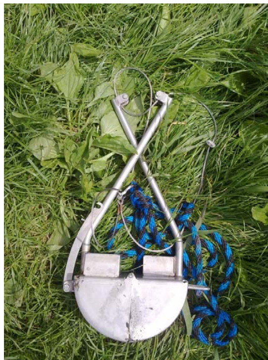
Obrázek 4: Drapák pro vzorkování sedimentu
