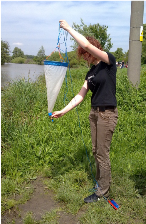
Obrázek 7: odběr zooplaktonu a fytoplaktonu pomocí planktonní sítě
