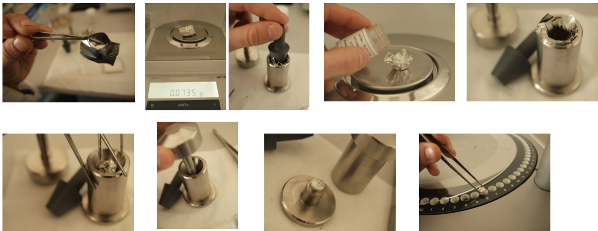
Obrázek 10: Příprava vzorku pro stanovení TC a TOC
