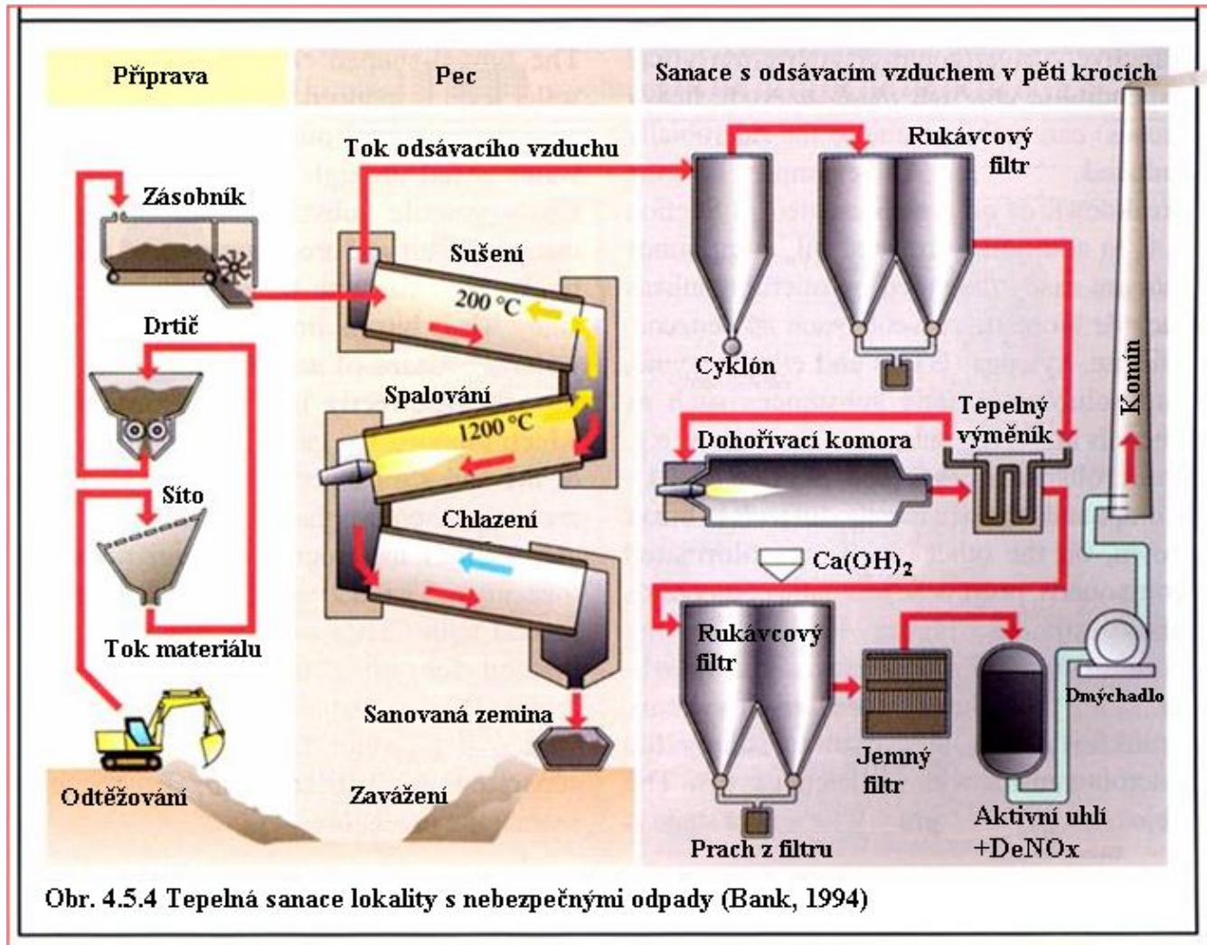
Obr. 4.5.4 Tepelná sanace lokality s nebezpečnými odpady (Bank, 1994)
