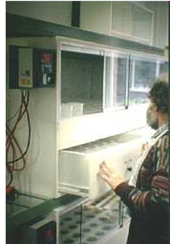
MacFadyenův extraktor pro suchou extrakci malých půdních vzorků (foto: ecoTech)
