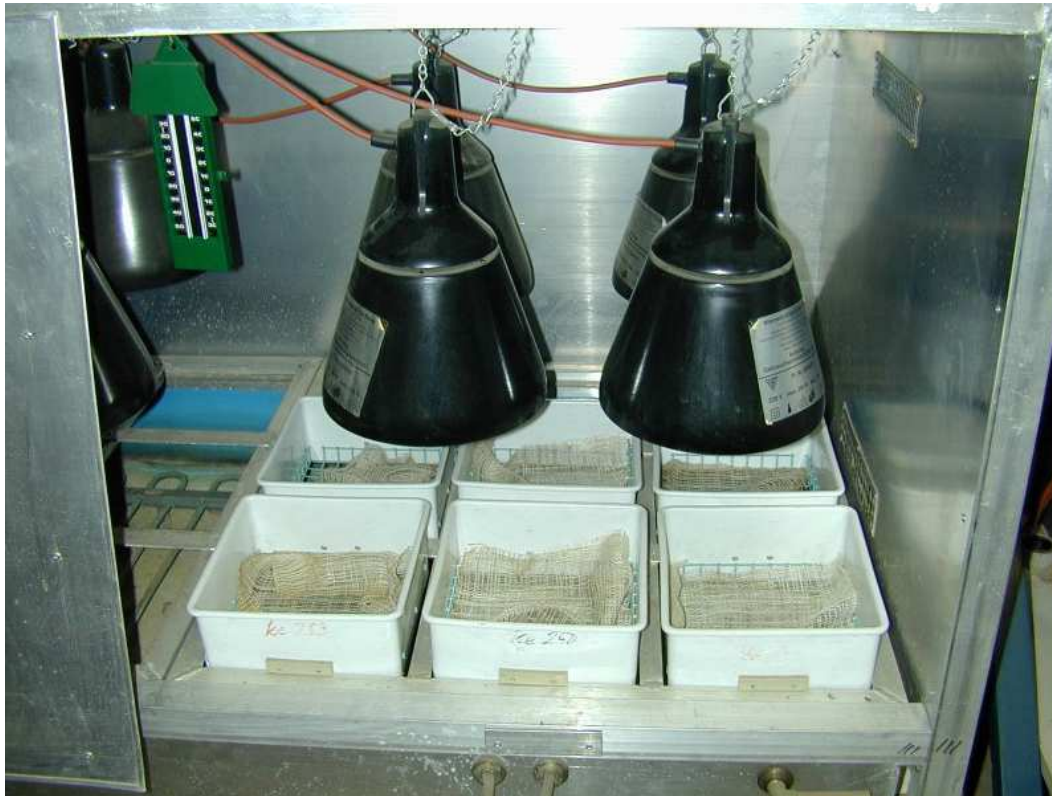
Kempsonův aparát pro suchou extrakci sérií velkých půdních vzorků (foto: Gerhardt Elsner)
