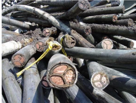
Kapalinou naplněné kabely
