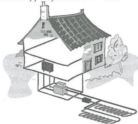
Obr. 8 Primární zdroj pro systém země – voda.
