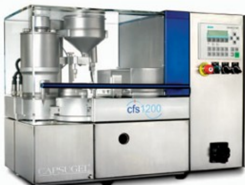
Příklad zařízení pro plnění a uzavírání tobolek
