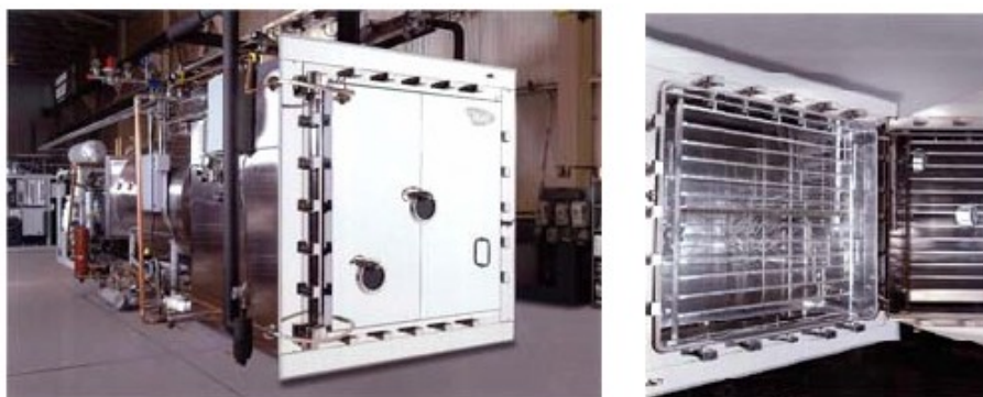
Průmyslové lyofilizační zařízení pro výrobu "suchých" injekcí
