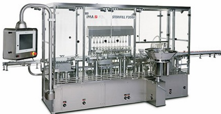
Příklady zařízení pro sterilní rozplňování kapalných injekcí a koncentrátů pro infuze
