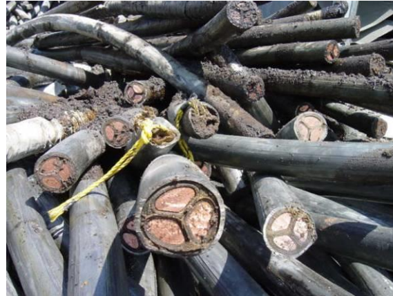
Kapalinou naplněné kabely
