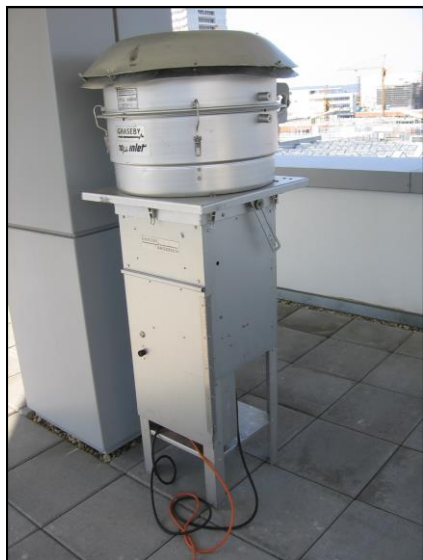
Odběrové zařízení Graseby-Andersen s kaskádovým impaktorem
