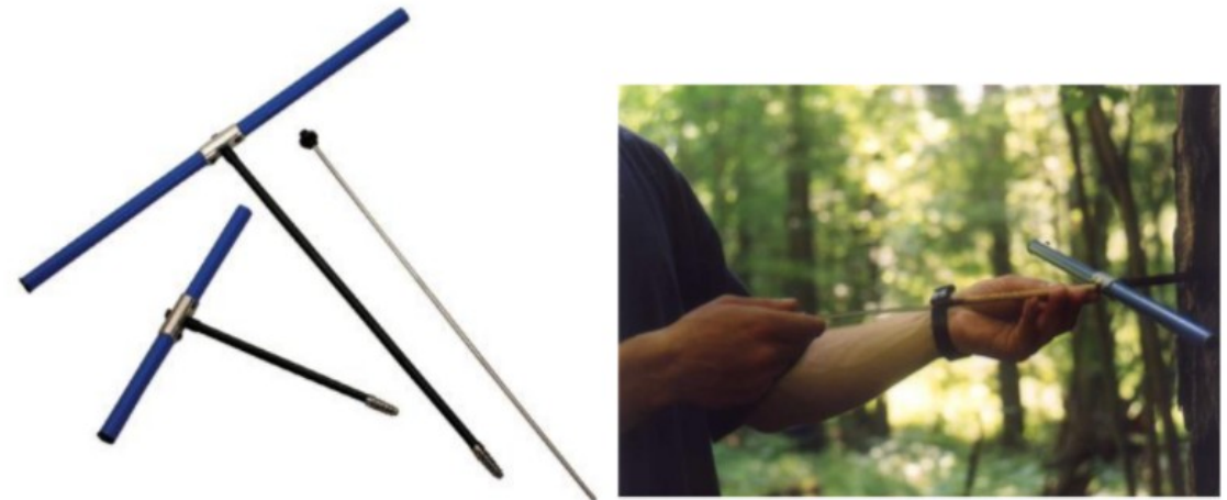
Świder przyrostowy (świder Presslera) – wywiarty, rdzenie
