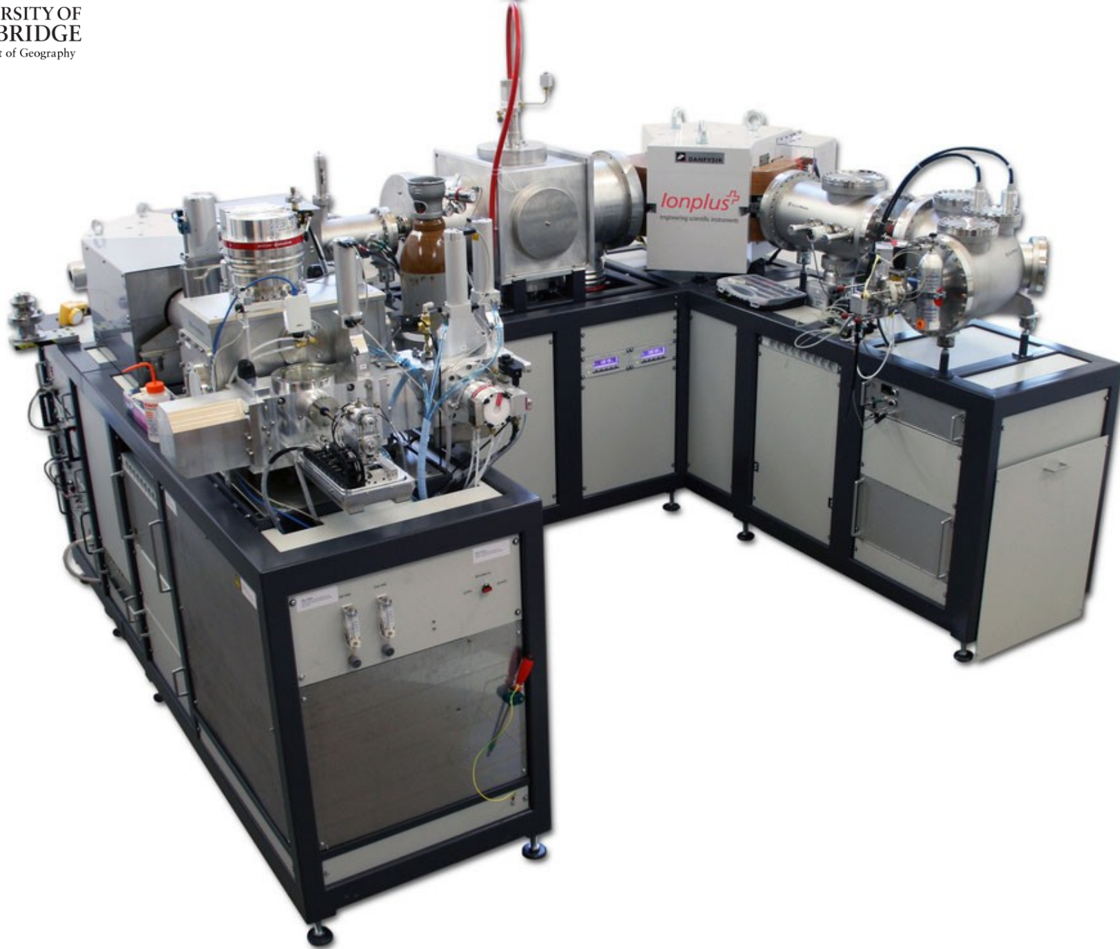
MICADAS - Mini Carbon Dating System ( https://www.ionplus.ch/products/micadas/ )
