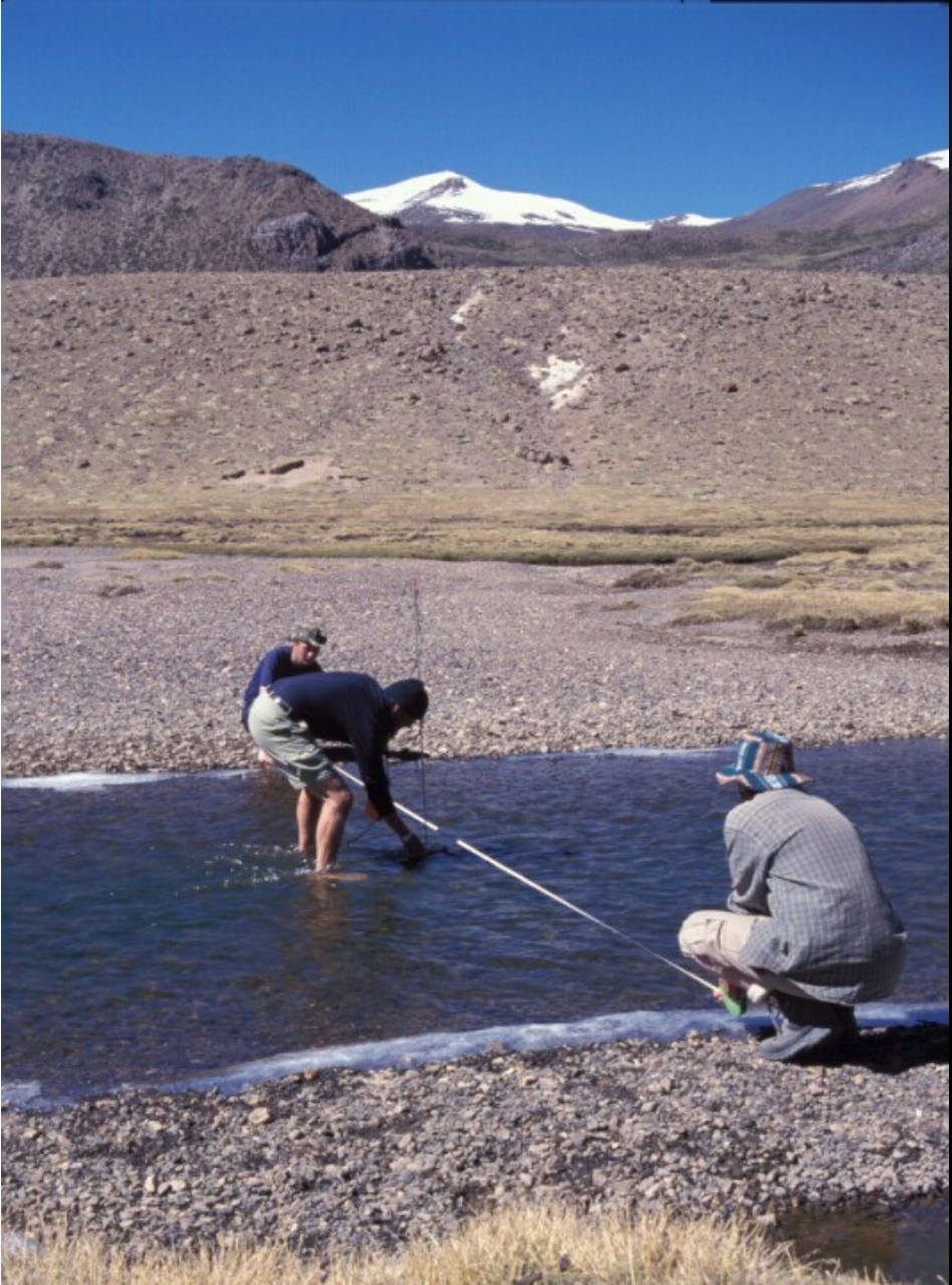
Durchflussmessungen in Rio Lloqueta
