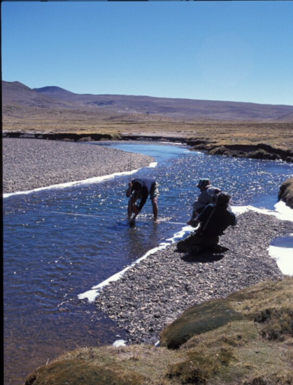
Durchflussmessungen in Rio Lloqueta
