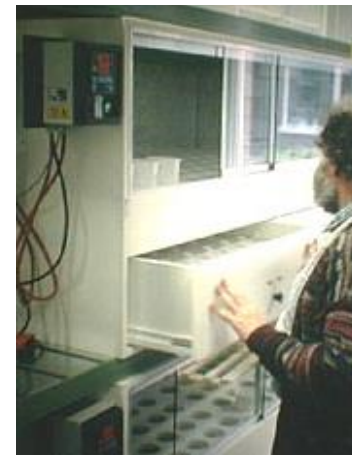
MacFadyen v extraktor pro suchou extrakci malých p dních vzork (foto: ecoTech)
