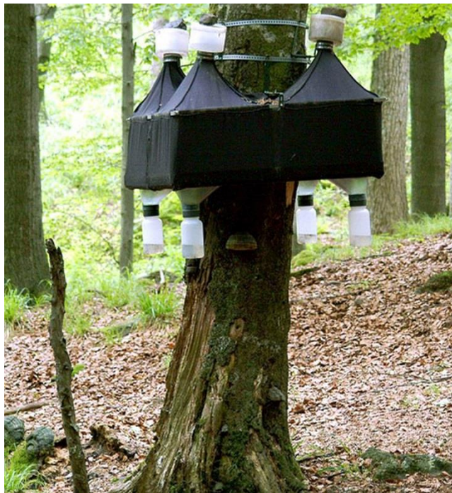
Otev ený stromový fotoeklektor Uzav ený stromový fotoeklektor (Výrobek firmy Behre; z Mühlenberg, 1989)
