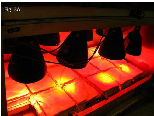
Kempson v aparát pro suchou extrakci sérií velkých p dních vzork (foto: Gerhardt Elsner)
