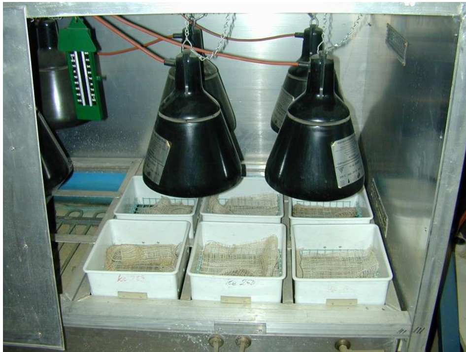
Kempson v aparát pro suchou extrakci sérií velkých p dních vzork (foto: Gerhardt Elsner)
