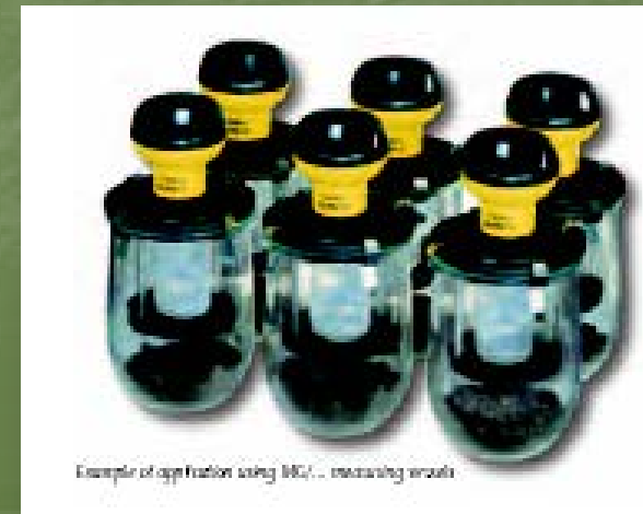
OxiTOP – měření respirace pomocí změny tlaku
