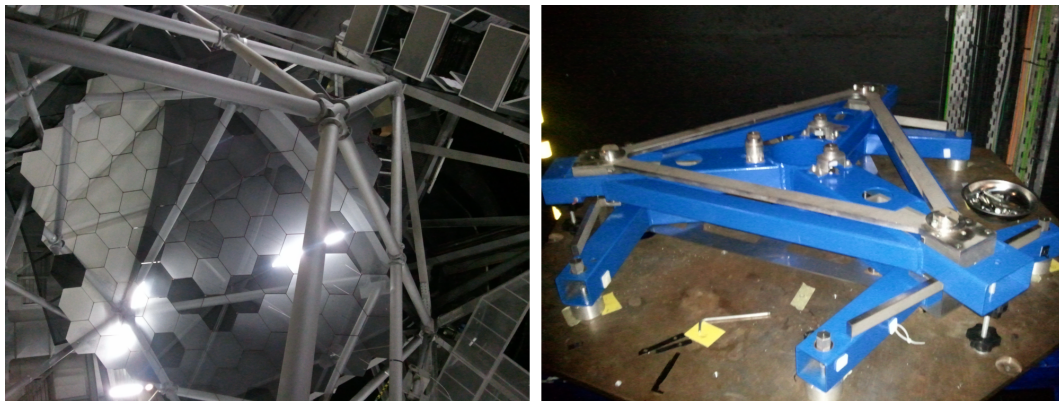
Obrázek 48: Segmentové zrcadlo dalekohledu SALT (South African Large Telescope, Sutherland - vlevo), na kterém je vidět různá kvalita odrazové plochy, vpravo je pak držák jednotlivého segmentu (foto autor).
