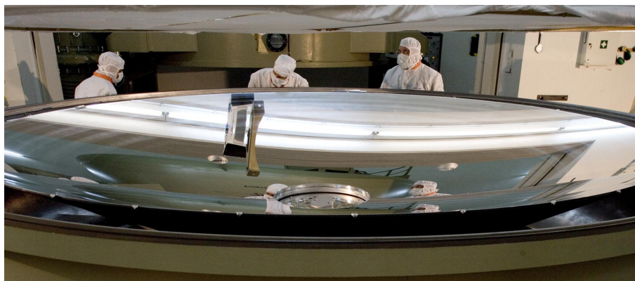
Obrázek 51: Aluminizace primárního zrcadla Herschlovy vesmírné observatoře [E32].
