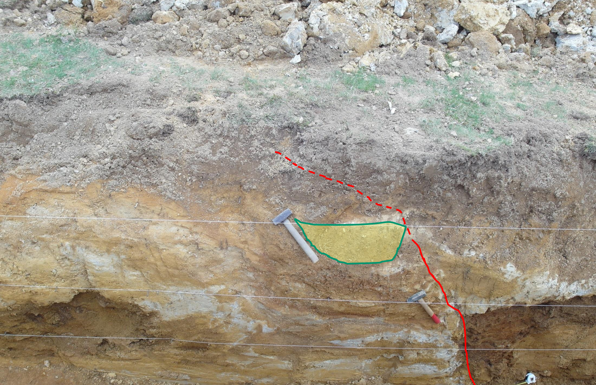
Rýha TE - stěna exponovaná k SV, korýtko s holocenními sedimenty utřené zlomem
