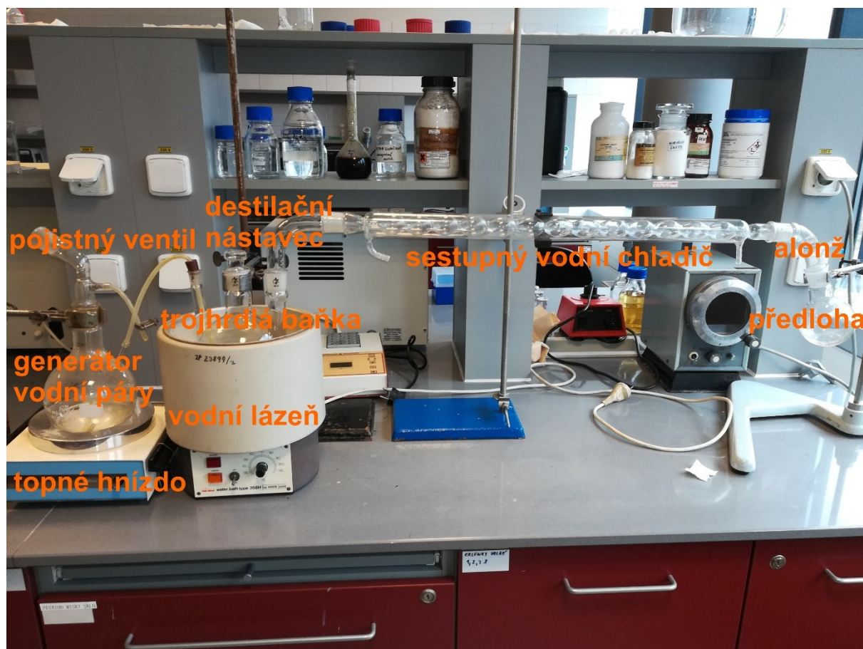
Schéma aparatury pro destilaci s vodní parou
