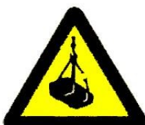
Pozor na zavěšené břemeno
