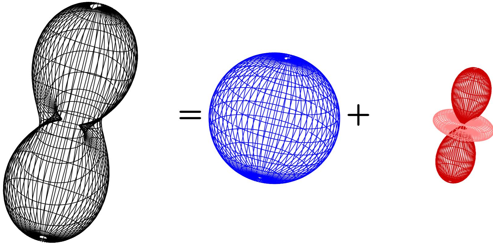
$$\vec{B}_e = \delta_i B_0 \begin{pmatrix} 0 \\ 0 \\ 1 \end{pmatrix} + \delta_a B_0 \begin{pmatrix} 3 \sin \vartheta \cos \vartheta \cos \varphi \\ 3 \sin \vartheta \cos \vartheta \sin \varphi \\ 3 \cos^2 \vartheta - 1 \end{pmatrix}$$
