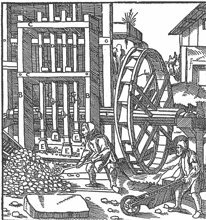
Stoupa k drcení surovin v 16. století. Agricola, [13] 1556. A – žlab stoupy B – sloupy stoupy C – příčník D – beran E – botka beranu F – osa G – zvedací čep H – palec na hřídeli
