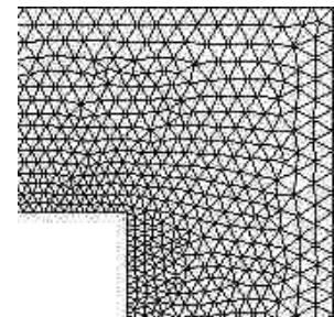
Aproximace se provádí s pomocí *tvarových funkcí*  $N^T[i]$  (lineárních, kvadratických ... obecně rádu  $k$ ) vztahujících uzel  $i$  s přilehlými elementy  $T$
