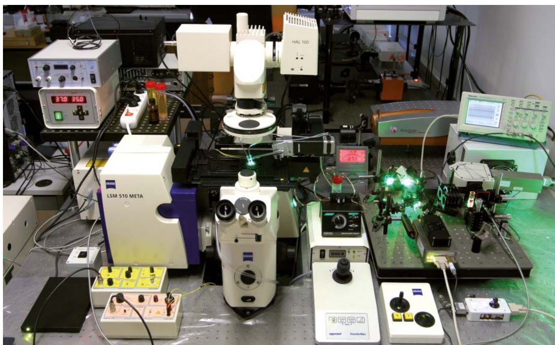
Obr. 2 Pracovná stanica pre laserovú mikroskopiu v Medzinárodnom laserovom centre v Bratislave tvorená motorizovaným invertovaným optickým mikroskopom, konfokálnym skenerom (vľavo), femtosekundovým laserovým systémom a spektrálne rozlíšeným časovo korelovaným počítaním fotónov (vpravo).
