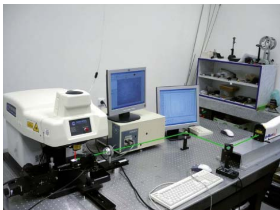
Obr. 6 Ortogonální double pulse LIBS na optickém stole – Ústav chemie, Masarykova univerzita v Brně: červeně ablační laser (266 nm – UP-266 MACRO , New Wave), zeleně reexcitační laser (1064 nm – Brilliant , Quandel) a spektrometr s ICCD kamerou (Jobin Yvon Triax 320 a Jobin Yvon Horiba).
