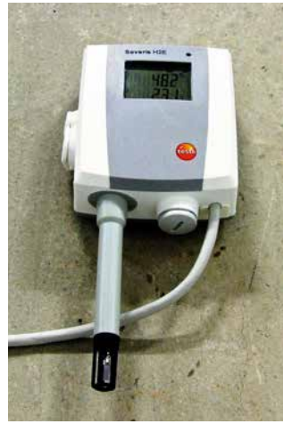
Fig. 72: Temperature and humidity sensors for the Testo Saveris System. (©: HLK, Heizung, Lüftung, Klima-Kältetechnik.)
