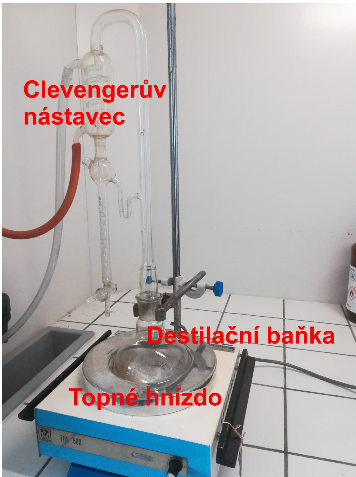
Schéma aparatury pro hydrodestilaci
