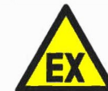
Nebezpečí – výbušné prostředí
