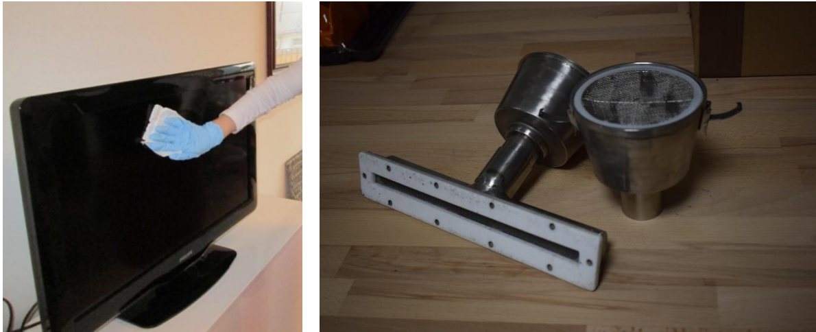
Obr. 1: a – vlhký stěr hladkého povrchu TV, b – nástavec na domácí vysavač pro vzorkování prachu, který je zadržen na křemenném filtru.
