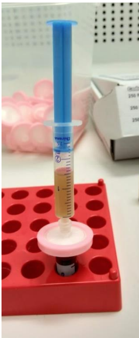
Obr. 7: Filtrace extraktu přes stříkačkový nylonový filtr
