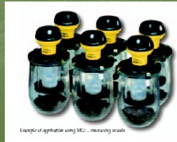
OxiTOP – měření respirace pomocí změny tlaku
