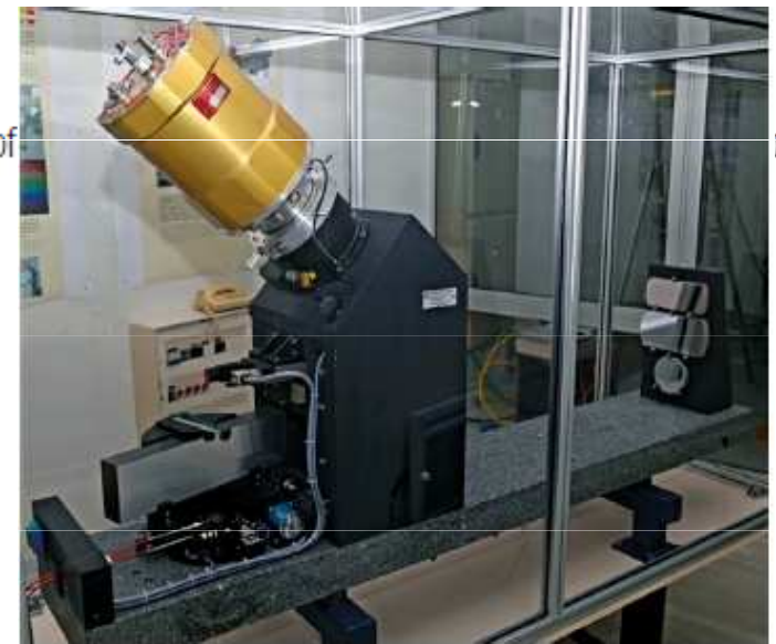
Obr. 1 Spektrograf ELODIE na observatoři OHP. Na levé straně je difrakční mřížka typu échelle. Optická vlákna (červená) přivádí signál do spektrometru. Nahoře je kryostat, v němž je umístěn CCD detektor. Optika se zkříženou disperzí je umístěna ve střední vertikální černé části.
