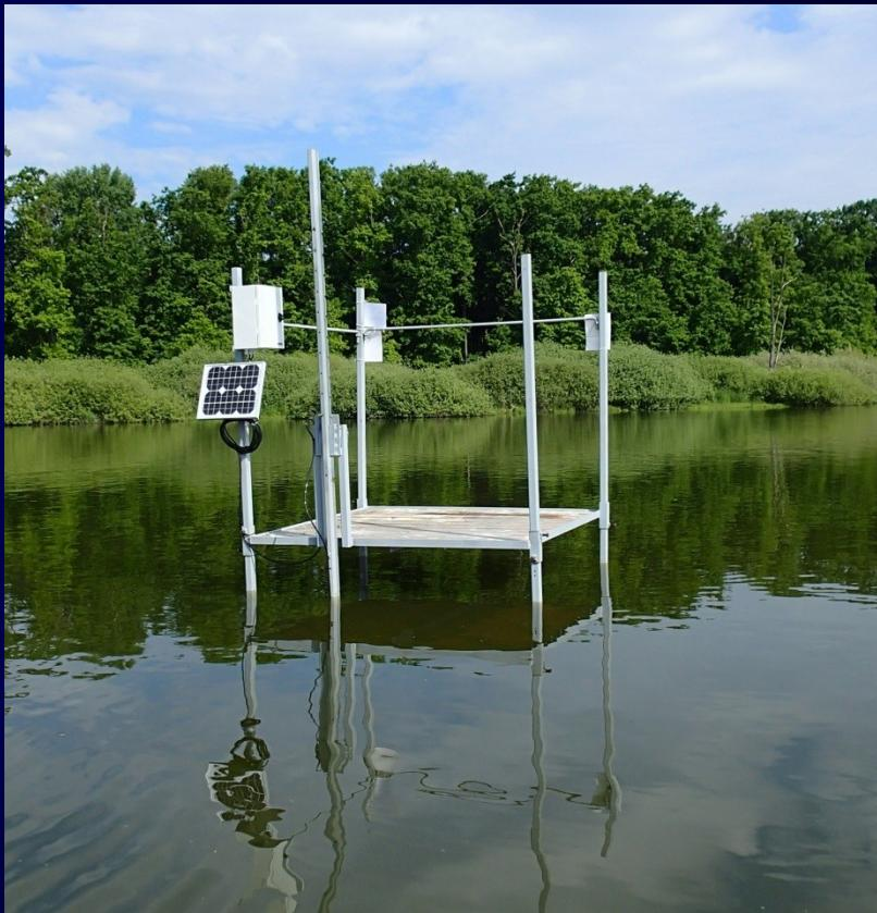
multiparametrická YSI sonda a monitorovací stanice
