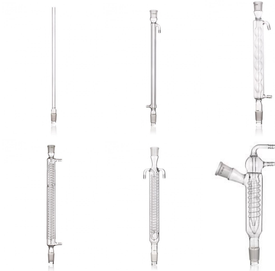
Vzdušný chladič, Liebigův chladič, kuličkový chladič dle Allihna, spirálový chladič dle Grahama, chladič dle Dimrotha, chladič dle Friedrichse
