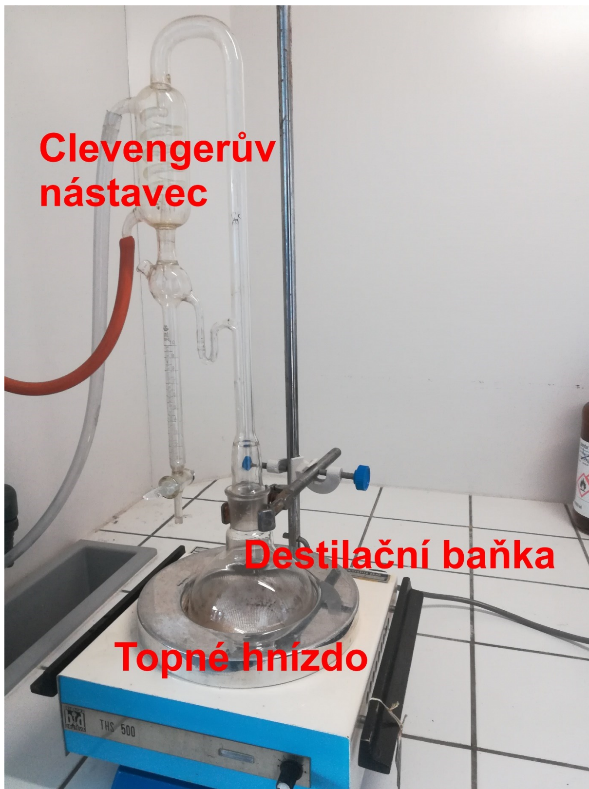
Schéma aparatury pro hydrodestilaci
