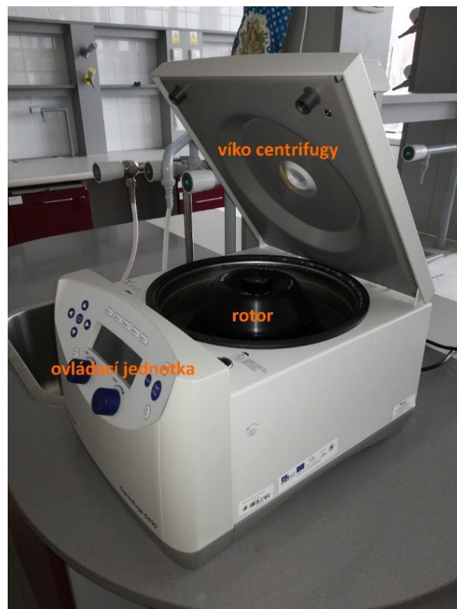
Chlazená stolní centrifuga s úhlovým rotorem
