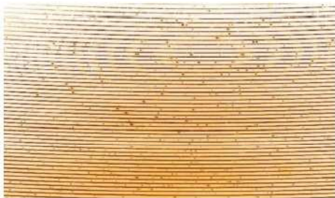
Obr. 2 Střední část hvězdného spektra zaznamenaného CCD detektorem ELODIE, spolu se spektrem thoria. Zakřivená posloupnost spektroskopických řádů spekter spolu s emisním spektrem thoriové lampy ozařující druhé optické vlákno.
