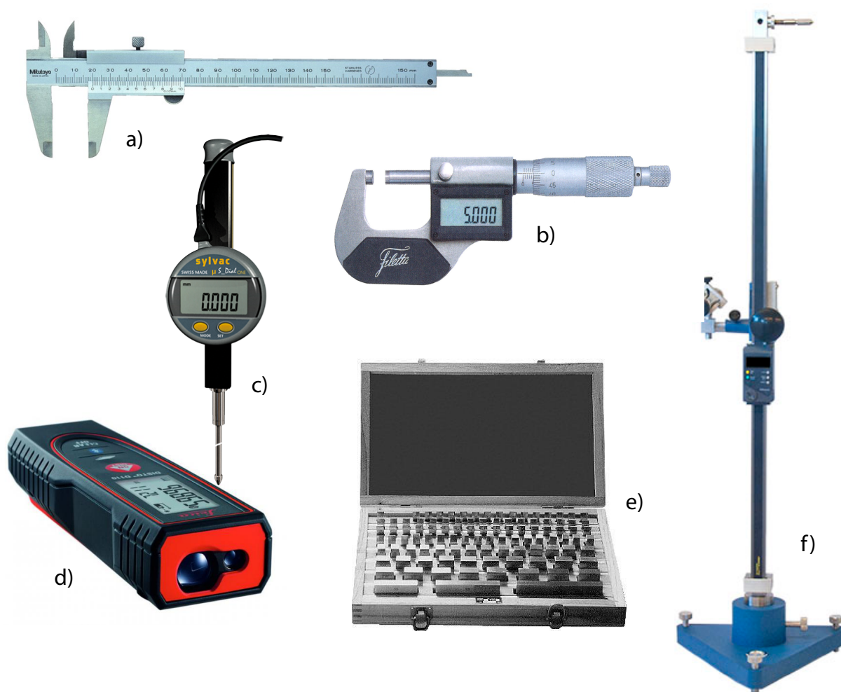
Obrázek 1: Měřidla délky: a) posuvné měřítko, b) mikrometr, c) úchylkoměr, d) laserový dálkoměr, e) koncové měřky, f) katetometr.
