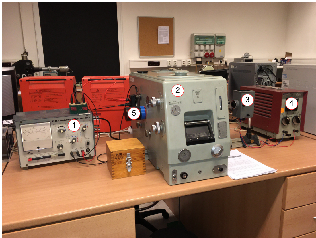
Obrázek 6: Aparatura pro měření úlohy: 1 - Voltmetr, 2 - Monochromátor, 3 - Žárovka, 4 - Zdroj napětí pro žárovku, 5 - Krytka s fotodiodou.
