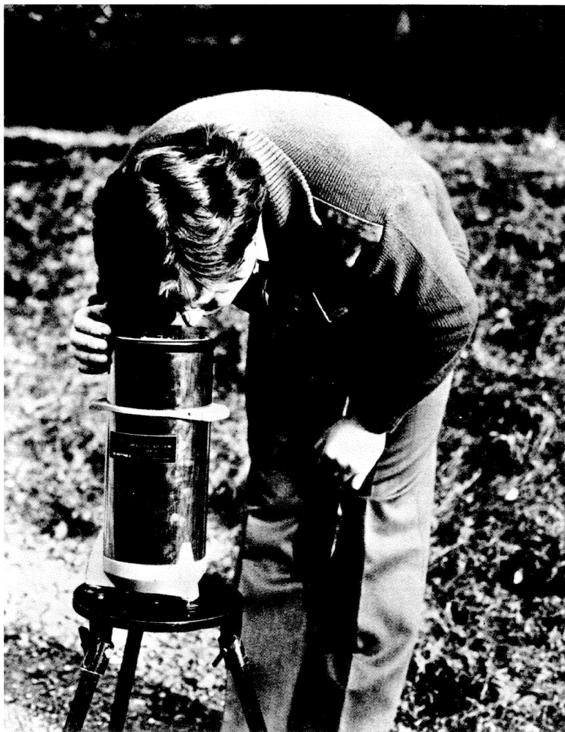
8.7 Měření gravimetrem (foto R. DUDA)
