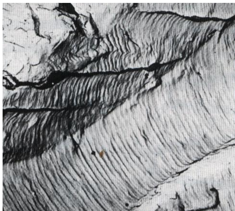
Obr.13.13. Mikrofotografie lomu hliníku (s charakteristickým žlábkováním).
